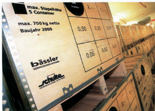
Stauchdruckprüfung bestanden: Die beladenen Container wiegen durchschnittlich 700 kg und werden im Block gestapelt.
